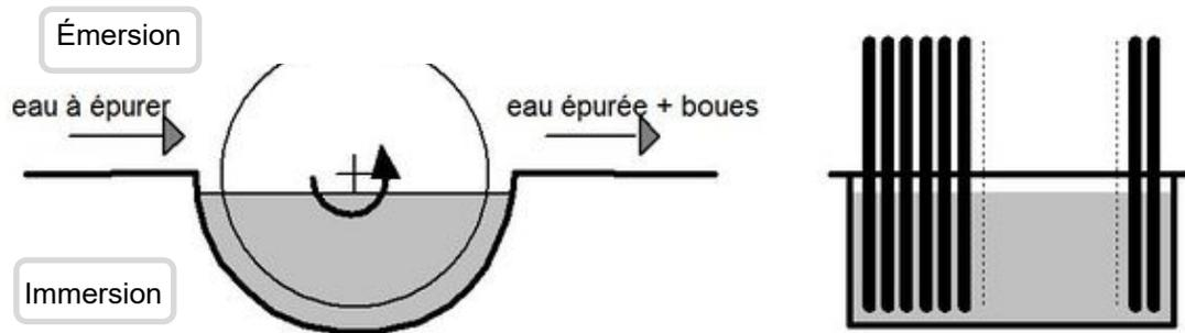
La nouvelle station d'épuration du Noyer utilisera un mode de traitement des eaux usées par disques biologiques.
