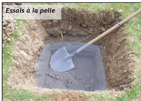
Le pétitionnaire réalise des tests pour évaluer la **capacité d'infiltration du terrain au droit de l'emplacement prévu pour la structure réservoir**. Il réalise 3 tests à la pelle manuelle à 50 cm de profondeur, en s'appuyant, pour la mise en œuvre et l'interprétation des tests, sur la fiche mise à disposition. A l'issue des tests, la vitesse d'infiltration de référence retenue est de  $1.10^{-6}$  m/s (3,6 mm/h).
