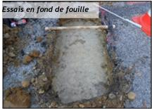
Le pétitionnaire réalise des tests pour évaluer la capacité d'infiltration du terrain au droit des emplacements prévus pour les dispositifs de gestion des eaux pluviales. Il réalise une dizaine de tests en fond de fouille à la pelle mécanique, en s'appuyant, pour la mise en œuvre et l'interprétation des tests, sur la fiche mise à disposition. A l'issue des tests, la vitesse d'infiltration de référence retenue est de 1.10-6 m/s (3,6 mm/h).
