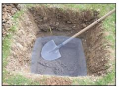
Le pétitionnaire réalise des tests pour évaluer la capacité d'infiltration du terrain au droit de l'emplacement prévu pour la noue. Il réalise 3 tests à la pelle manuelle à 50 cm de profondeur, en s'appuyant, pour la mise en œuvre et l'interprétation des tests, sur la fiche mise à disposition. A l'issue des tests, la vitesse d'infiltration de référence retenue est de 5.10-6 m/s (18 mm/h).
