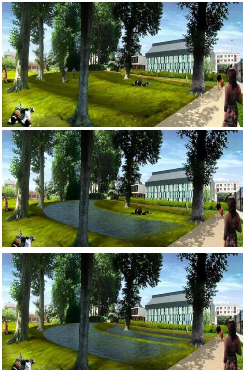
*Figure 7 : Exemple d'une solution intégrée, multifonctionnelle, à inondation progressive*
