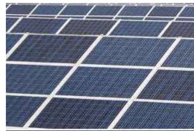
Les panneaux poly cristallins à facettes, les lignes argentées apparentes.
