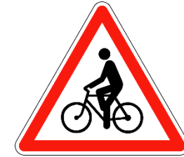
A21 débouché de cycliste
