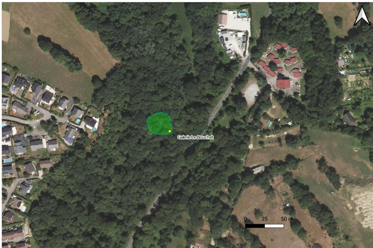
Figure 10 : Nouveau zonage de l'aléa effondrement localisé sur la commune de Sonnaz (secteurs de Sonnaz 1 et 2) – Fond BDOrtho© IGN (en bleu : ancien contour de l'aléa effondrement localisé, en vert : nouveau zonage de l'aléa effondrement localisé de niveau faible sur travaux miniers souterrains)
