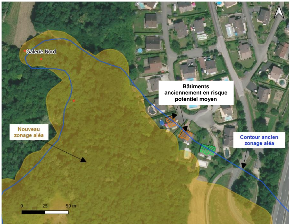
Figure 16 : Nouvelle cartographie de l'aléa effondrement localisé sur le secteur Nord de l'ancienne concession de la Creuse – Commune de Voglans - Fond BD ORTHO® IGN
