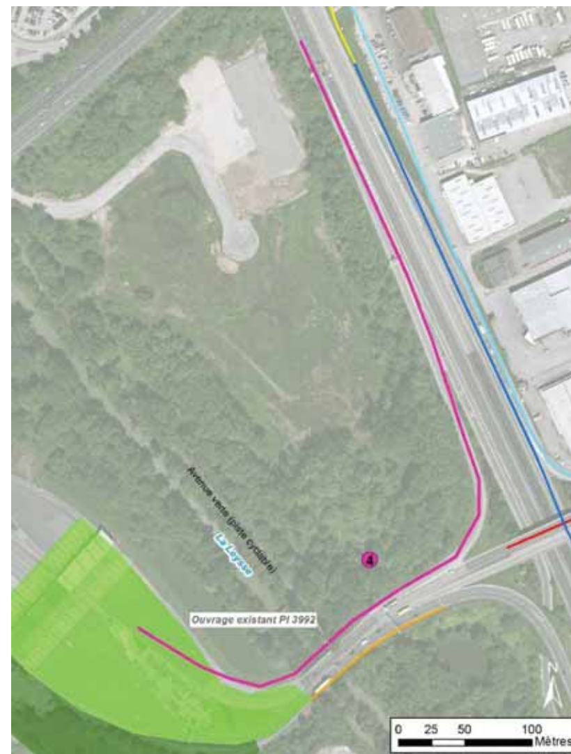
Figure 5 : Vue en plan (tracé indicatif) de la bretelle VRU nord vers péage (source Egis, mars 2017)
