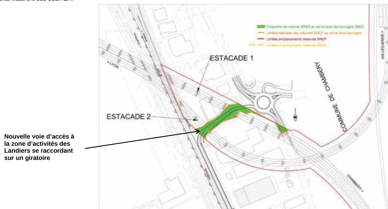
Figure 7 : Vue en plan de l'emplacement réservé volumétrique au droit de l'estacade (source Egis, novembre 2017)
