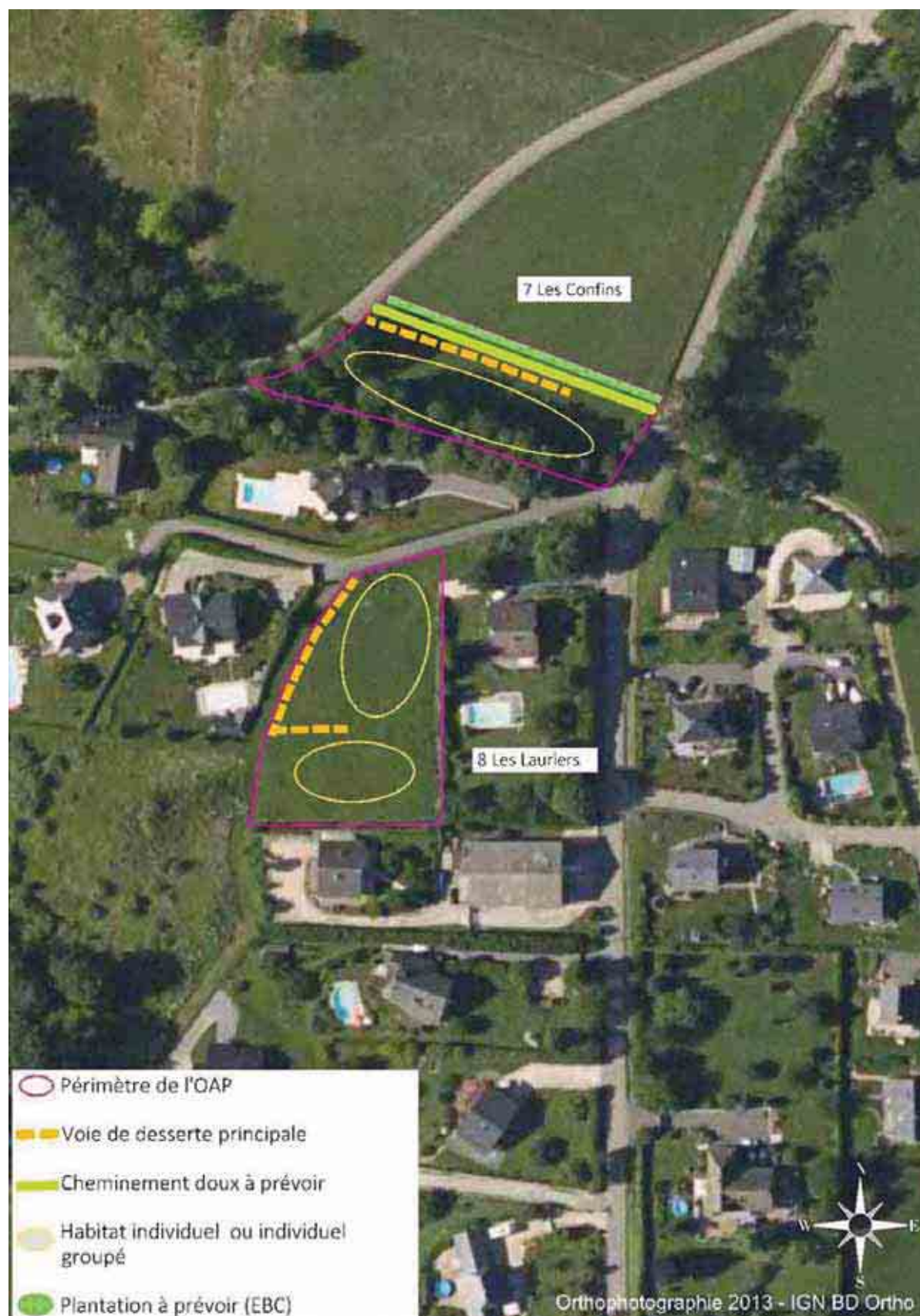
Figure 3 : Orientation d'aménagement et de programmation des Confins et des Lauriers
