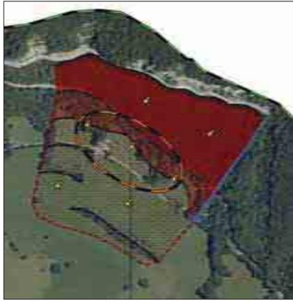
Ce glissement de versant affecte les éboulis en pied d'escarpement. Le substratum mameux peut également jouer un rôle dans le mouvement vers l'aval. Les zones d'arrachement sont visibles, de même que les ruptures de pente.
