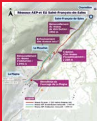
*Travaux d'enfouissement des réseaux jets au Mouchet par le Syndicat Départemental d'Énergie de la Savoie (SDES) et par la commune de Saint-François-de-Sales.
