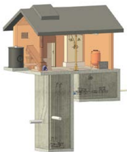
Schéma du poste de relèvement « principe PR87 »
