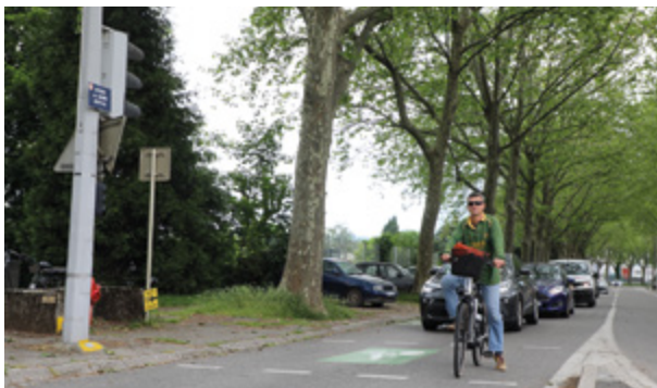
Aux feux de circulation, le sas vélo permet aux cyclistes d'être bien en vue devant les véhicules motorisés pour démarrer en toute sécurité.
