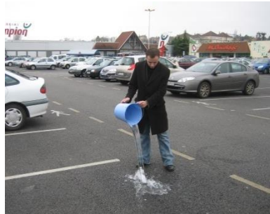
Structure réservoir sous parking avec enrobé poreux
