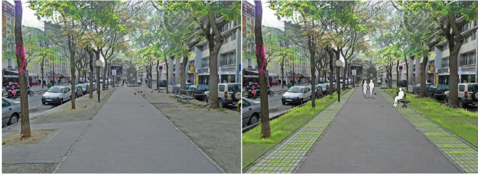
Espace vert « en creux » collectant les eaux de trottoirs et chaussée (source : Est Ensemble)
