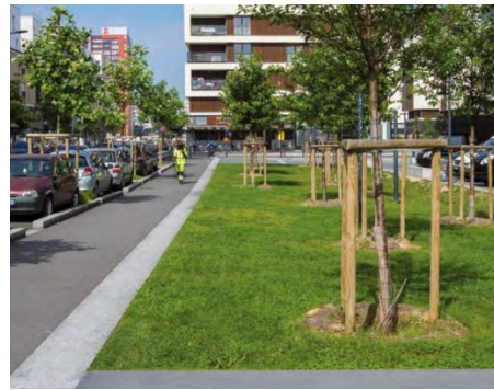
Espace vert « en creux » collectant les eaux de trottoirs et chaussée (source : Est Ensemble)
