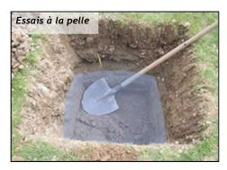
Le pétitionnaire réalise donc des tests pour évaluer la capacité d'infiltration du terrain au droit de l'emplacement prévu pour la noue.
